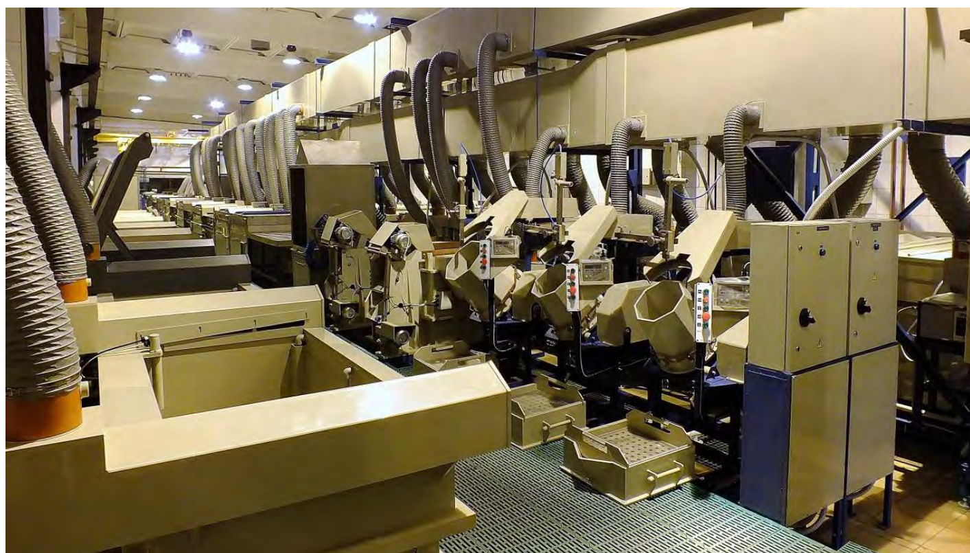
Линия нанесения цинкового покрытия на малогабаритные детали насыпным способом
